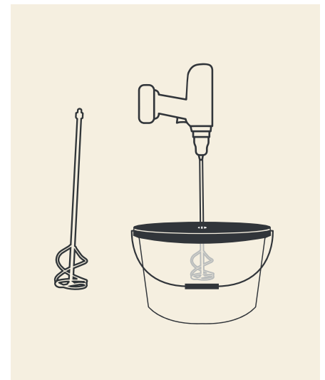
Rührstab an Bohrmaschine – nur bei geschlossenen Deckel mischen
