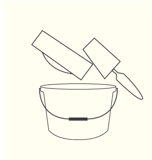
Entnehmen des Mörtels
